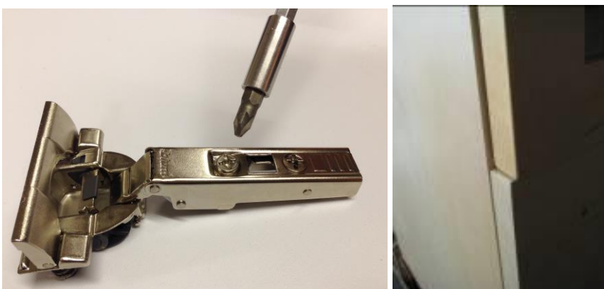
Bild vänster: Justerskruv på gångjärnet. Högerbild: Dörrens läge indikerar justering!
